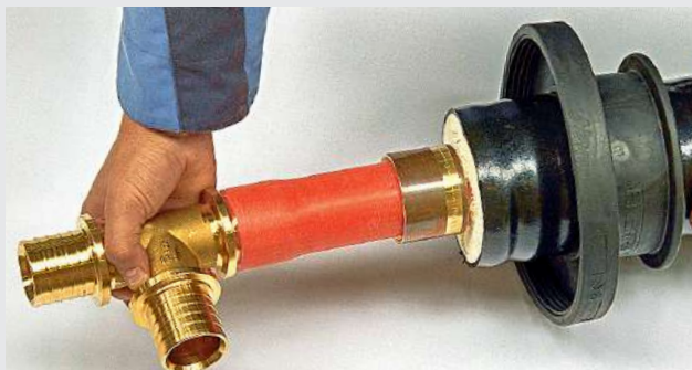
Stützkörper bis zum letzten Steg einstecken.
